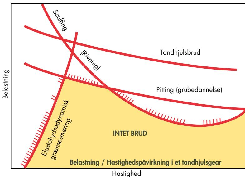
Koniske- og cylindriske gear (DIN 51509)
