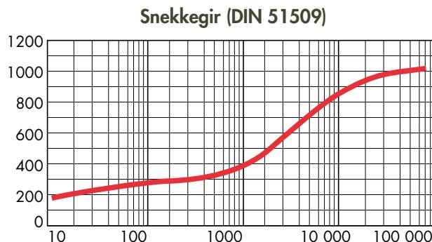
$$\text{Belastning-hastighetsfaktorer} = \frac{T_2}{n \alpha^3} \left( \frac{N \cdot \text{min}}{\text{m}^2} \right)$$
