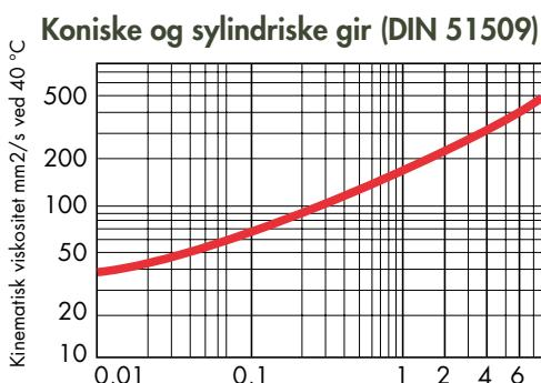
$$\text{Belastning-hastighetsfaktorer} = k_s / v \left( \frac{N \cdot S}{\text{mm}^2 \cdot \text{m}} \right)$$
